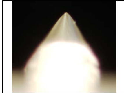
Abb.1: Querprofil EROICA LX - Abnutzung
