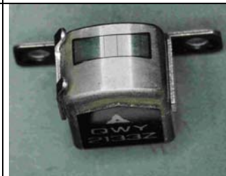
Abb.22: Doppelspaltlöschkopf mit Sendustschutz
