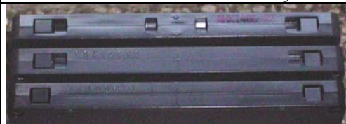
Abb.35: Kassettenrücken mit Kodieröffnungen
