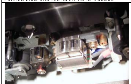
Abb.63: Tonkopfschlitten mit Löschkopf, Aufnahme- und Wiedergabekopf, Capstan-Antrieb links und rechts im TEAC V6030S
